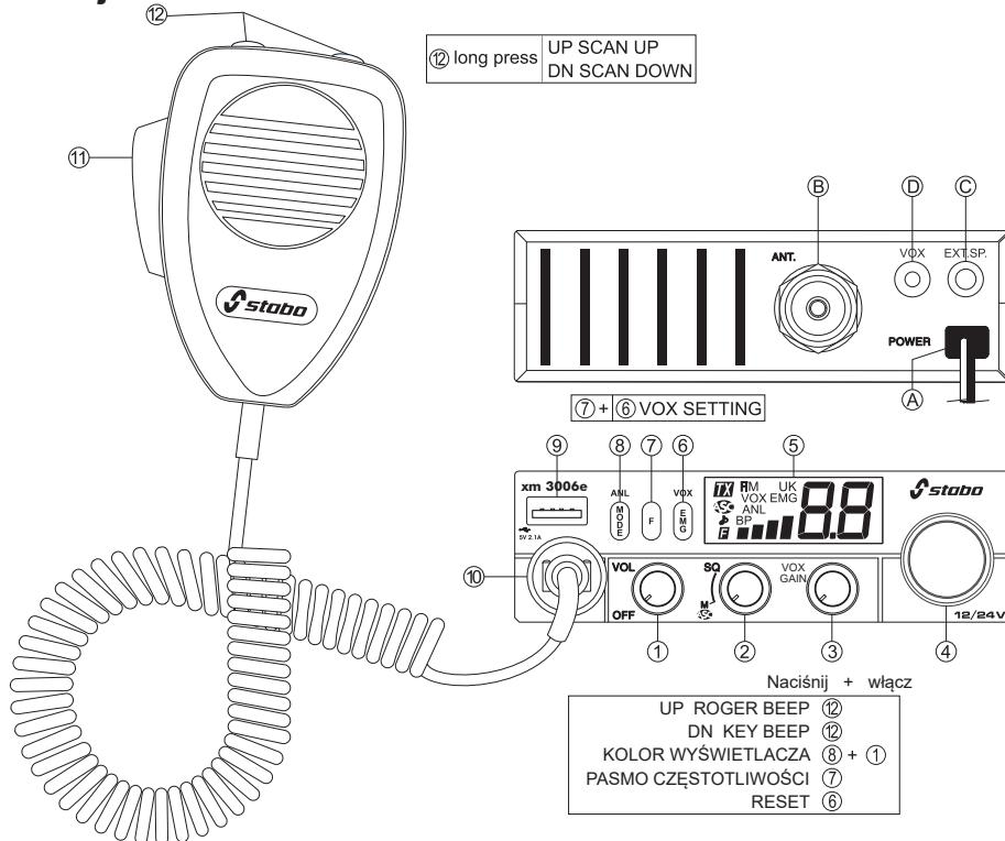
**1** ON/OFF - Volume (włącznik/wyłącznik z funkcją regulacji głośności)
